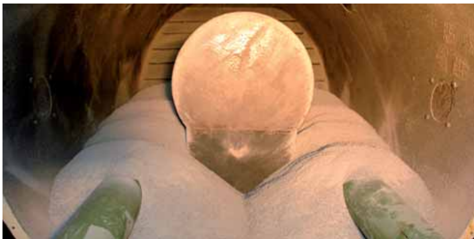
Das Tunnel-Modell wird im Teststollen mit Bentonit-Granulat gefüllt.
