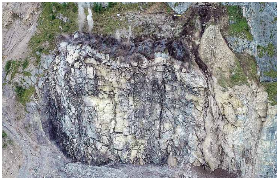
Gewinnungssprengung (15'000m 3 ) im Steinbruch Reutigen (BE)
